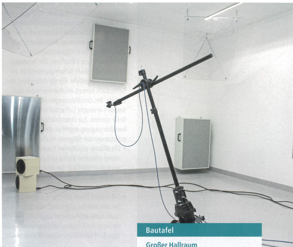
Abb. 3: Der Empfangsraum (unterer Trittschallraum)
