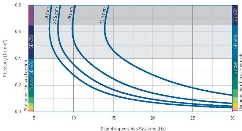
Eigenfrequenz eines Systems, bestehend aus einer kompakten Masse und einer elastischen Lagerung aus Vibrafoam® SD400 auf starrem Untergrund, Formfaktor  $q=3$
